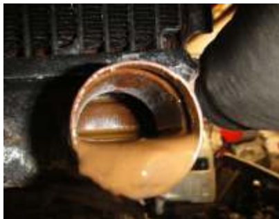
Boue rouillée provenant du radiateur
